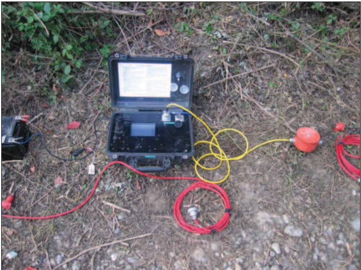
Figura 1 - Sismografo EEG con geofono triassiale in fase di acquisizione
