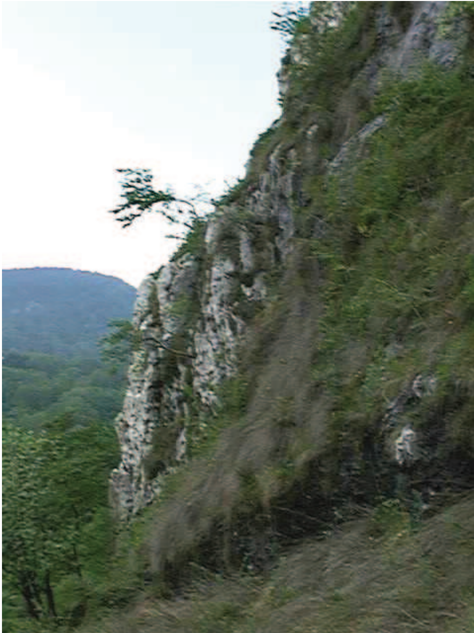
Foto 7: particolare dell'affioramento di Dolomia Principale posta a NE di Barni nei pressi della quale è stato fatto il rilievo geomeccanico. Si noti l'elevata acclività del versante e l'aspetto fratturato della roccia.
