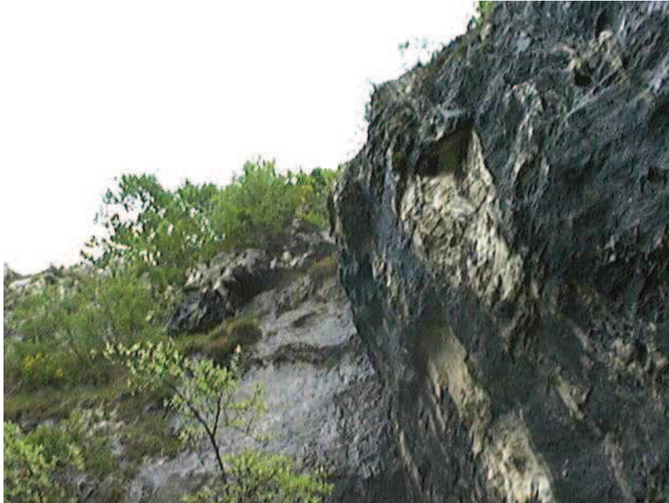
Foto 8: altro particolare dell'affioramento oggetto del rilievo geomeccanico; qui appare evidente l'elevata circolazione idrica che interessa l'ammasso roccioso che provoca la formazione di una patina superficiale di alterazione in sali di calcio.
