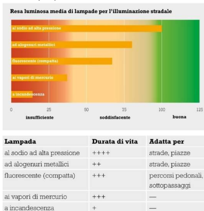
Figura 6. Resa luminosa e caratteristiche delle lampade installate nelle strade Italiane prima dell'avvento del LED.
