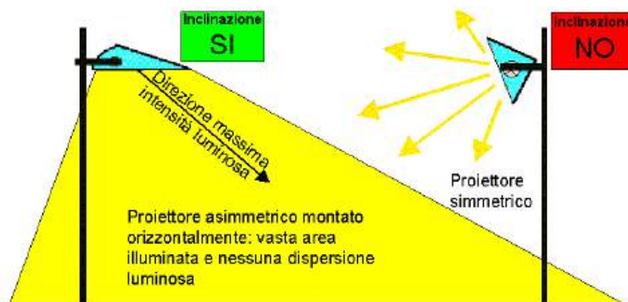
Figura 5. Sopra, esempi di impianti di illuminazione non conformi alle disposizioni della nuova legge regionale veneta in quanto il fascio luminoso si disperde verso il cielo stellato.
