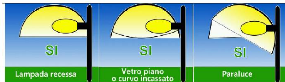
Fig. 2 – Apparecchi conformi alla L.r. 17/09.
