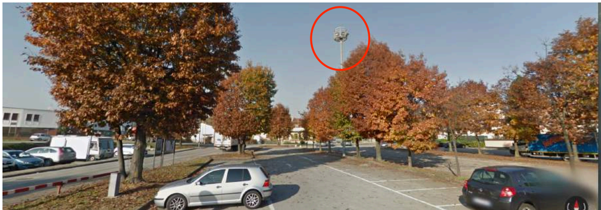
Figura 65. Area d'interesse pubblico di Arosio con illuminazione privata/pubblica non conforme a causa del corpo lampada che in questo caso proietta oltre i 90°. Fonte: elaborazione personale.
