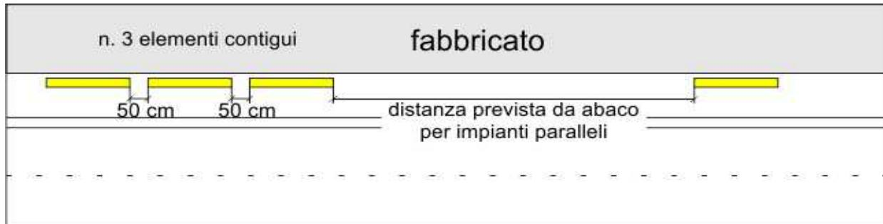
In caso di impianti luminosi o illuminati le distanze indicate per l'applicazione della normativa, ad eccezione di quella dalla carreggiata, sono da aumentate del 50%.
